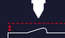
При включении функции SOP система не реагирует на капли металла, остающиеся на поверхности, поэтому не меняет фокусное расстояние и достигается максимальное качество резки. Данная система актуальна при раскрое большого количества мелких деталей на небольшом участке металла.
