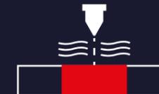
Данный метод прожига применяется при раскрое толстых листов металла. Сначала происходит предварительный прогрев зоны резки, затем оптическая голова опускается в фокус и происходит прожиг. Дополнительно установленная система обдува удаляет оставшиеся капли металла.
