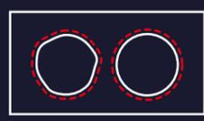
Позволяет вырезать отверстия более высокого качества. Автоматическая система задания контура и контроля давления газа – технология PFC – значительно улучшает качество раскроя.
