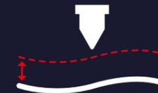
Высокоточная система автоматического слежения за поверхностью листа обеспечивает зазор между оптической головой и поверхностью металла с точностью до 0.025 мм в широком диапазоне высот. Это позволяет получить качественный рез на всей поверхности металла, не привязываясь к толщине.
