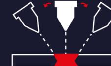
Лазерная голова отклоняется от вертикали от  $-45^\circ$  до  $+45^\circ$ . Функция BEVEL позволяет получать детали с различными формами фасок за одну операцию.
