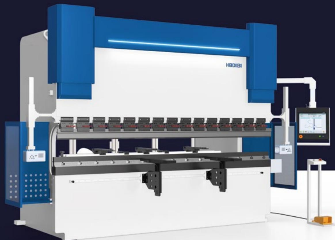
Серия HBD - это ваш идеальный выбор для высокопроизводительной гибки металла без ограничений. Увеличение производительности на 200%! Гидравлические прессы с ЧПУ от HL оснащены двойным серводвигателем и двойным масляным насосом. Сенсорный дисплей позволяет легко программировать операции в 2D и 3D и контролировать весь процесс производства.
